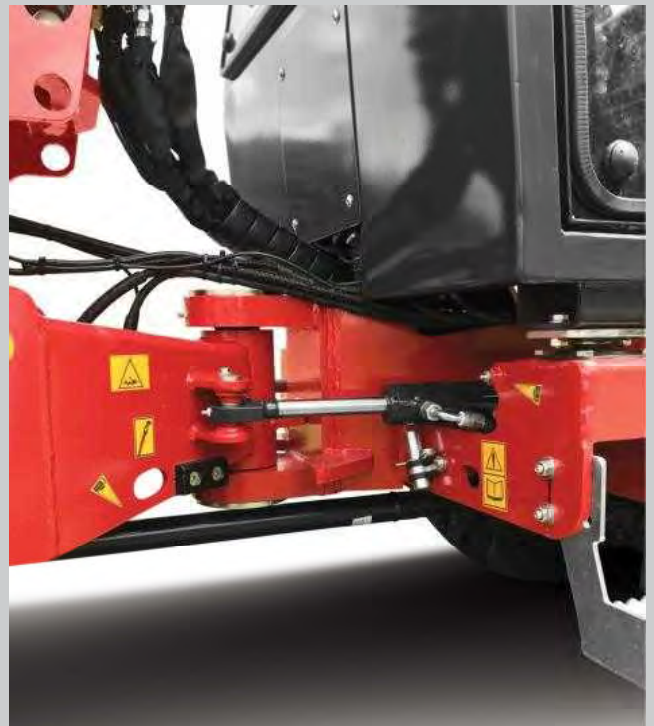
Stabiles Knickgelenk mit 2 Lenkzylindern
