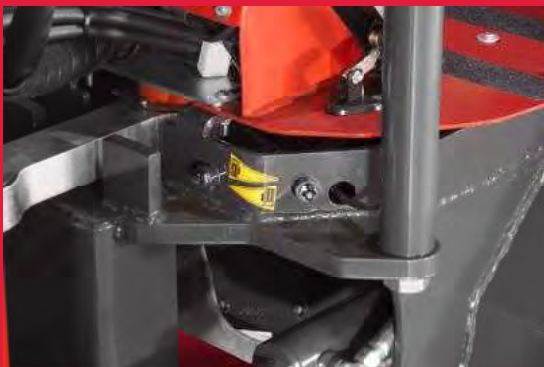
Alle Schmierstellen sind nach außen gelegt
