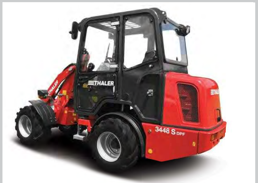
Kompakt / wendig / standfest - mit Pendelachse und Blattfedern zur Stabilisierung
