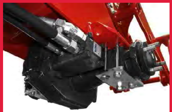
Ein Hydrostat versorgt die Ölmotoren auf den Achsen
