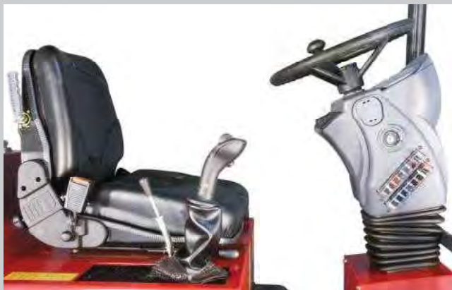
Einhebelbedienung - Verstellbare Lenksäule
