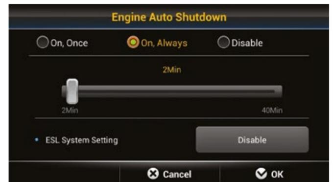
Der **Motor wird bei Untätigkeit automatisch ausgeschaltet**, um den Verbrauch zu drosseln und unnötige Emissionen zu vermeiden. Je nach Arbeitsumgebung können unterschiedliche Betriebsarten ausgewählt werden, was die Effizienz weiter erhöht.
