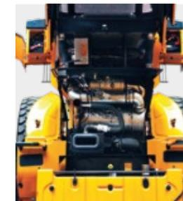
Die **elektrisch zu öffnende Motorhaube ist voll einziehbar**, womit der abgedichtete Motorraum und der Kühlraum leicht erreichbar sind. Die Brandgefahr im Motorraum durch zufließende Fremdmaterialien wurde eingedämmt.
