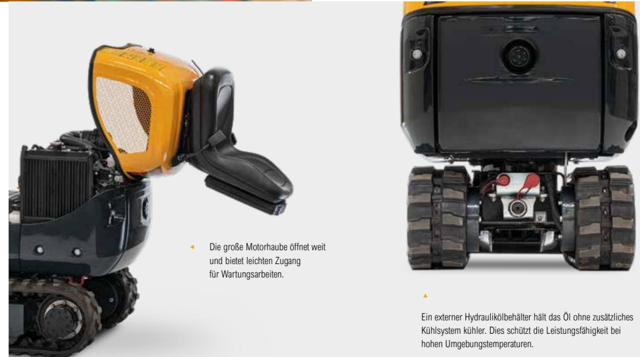
◀ Die große Motorhaube öffnet weit und bietet leichten Zugang für Wartungsarbeiten.
