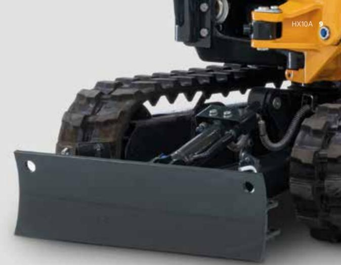
Der verlängerbare Planierschild ermöglicht das Planieren über die volle Breite der Kette.
