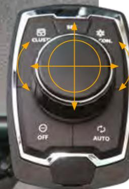
Beschleunigungsfunktion, Fernbedienung der Klimaanlage, und Kombiinstrument können mit der praktischen **haptischen Jog-Shuttle-Steuerung** bedient werden.
