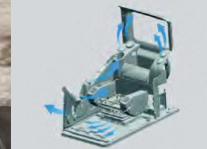
Das **Heizungs- und Klimatisierungssystem** sorgt für eine effiziente Regulierung und Ausrichtung des Luftstroms in der Kabine.
