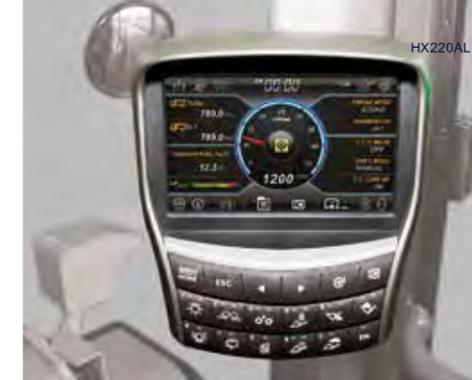
Die **Instrumententafel** ist für schnellen, einfachen Zugriff auf Maschinenstatusinformationen während der Arbeit optimiert. Sie enthält einen leicht ablesbaren **8"-Touchscreen**.
