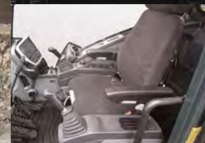
Der HX220AL verfügt serienmäßig über einen **luftgefederten beheizbaren Sitz**. Die **ergonomischen Joysticks** ermöglichen eine komfortable, intuitive Bedienung.
