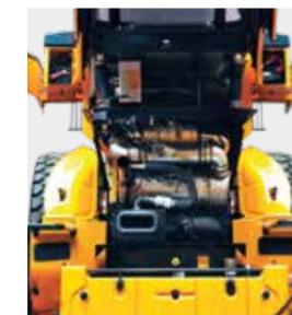
Die **elektrisch zu öffnende Motorhaube lässt sich weit aufstellen**, womit der Motorraum und die Kühler leicht erreichbar sind. Die Brandgefahr im Motorraum durch Fremdstoffe wurde durch eine zuverlässige Abdichtung eingedämmt.
