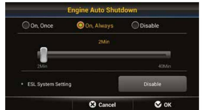
Der **Motor wird nach einer definierten Leerlaufzeit automatisch ausgeschaltet**, um den Verbrauch zu drosseln und unnötige Emissionen zu vermeiden. Je nach Arbeitsumgebung können unterschiedliche Betriebsarten ausgewählt werden, was die Effizienz weiter erhöht.
