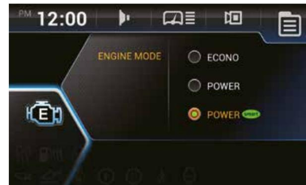
Der neue **Smart-Power-Modus** passt die Motordrehzahl bei harten Einsatzbedingungen, etwa beim Ausschachten, an, um ohne Zugeständnisse an die Leistung Kraftstoff zu sparen. Mit dieser Technologie wird auch ein optimales Gleichgewicht zwischen Traktion und Ausbrechkraft erreicht.
