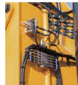
Mit dem optionalen **automatischen Schmiersystem** wird bei Bedarf automatisch Fett an die Schmierstellen gebracht. Die korrekte Dosierung wird gewährleistet und Schmiermittel wird gleichmäßig aufgetragen, um den Fettverbrauch zu reduzieren und Abfälle zu eliminieren.
