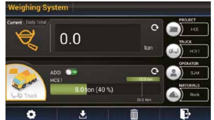
Das kumulative **Präzisionswiegesystem mit Automatik- und Manuell-Einstellung** hilft Ihnen, in jeder Umgebung effizienter zu arbeiten. Zur Erhöhung der Präzision erscheinen bei Wiegefehlern Symbole und eine zweifarbige Gewichtswertanzeige im Display.
