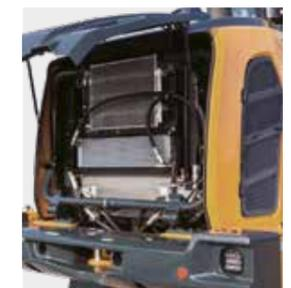
Der HL970A verfügt über einen **Lamellenkühler mit großen Durchgängen**, die Leistungseinbußen durch Verschmutzung zuverlässig verhindern.
